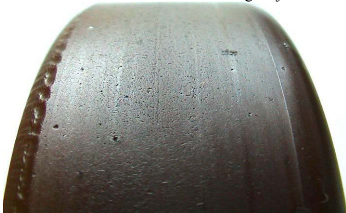
Abbildung 2.15 Vulkollanrad mit einer 92 Shore-A-Bandage und \varnothing 100 mm nach 24 h Versuchsdauer unter Einwirkung von Metallspänen und Schneid-Kühl-Emulsion als Zwischenstoff
