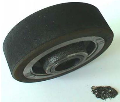
Abbildung 2.14 Vulkollanrad nach der Untersuchung unter Einwirkung von Metallspänen mit den aus der Bandage entfernten Einlagerungen
