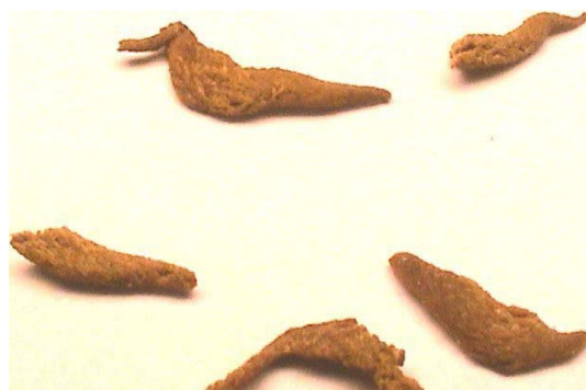
Abbildung 2.8 Vulkollanrad mit einer 92 Shore-A-Bandage und \varnothing 100 mm nach 24 h Versuchsdauer unter Einwirkung von Wasser als Zwischenstoff, rechts: abgespülte Abriebspartikel
