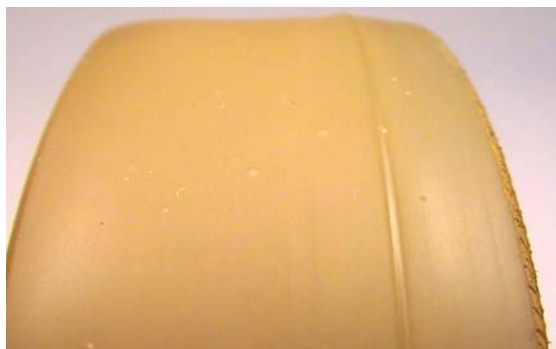
Abbildung 2.8 Vulkollanrad mit einer 92 Shore-A-Bandage und \varnothing 100 mm nach 24 h Versuchsdauer unter Einwirkung von Wasser als Zwischenstoff, rechts: abgespülte Abriebspartikel
