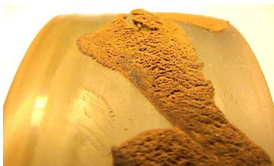
Abbildung 2.9 Vulkollanrad mit einer 80 Shore-A-Bandage und \varnothing 100 mm nach 24 h Versuchsdauer unter Einwirkung von Wasser als Zwischenstoff, rechts: Vergrößerung der Oberfläche
