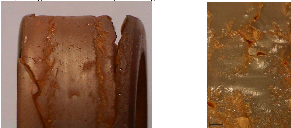
Abbildung 2.17 Vulkollanrad mit einer 85 Shore-A-Bandage und \varnothing 100 mm nach 24 h Versuchsdauer unter Einwirkung von Salzwasser mit Streusplitt als Zwischenstoff, rechts Vergrößerung
