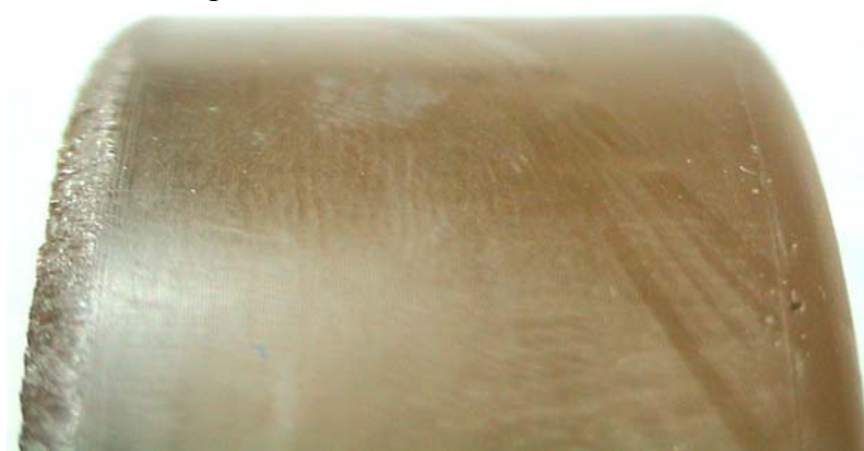
Abbildung 2.10 Vulkollanrad mit einer 85 Shore-A-Bandage und \varnothing 100 mm nach 24 h Versuchsdauer unter Einwirkung von Schneid- Kühl- Emulsion als Zwischenstoff
